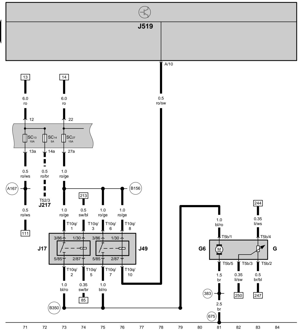
燃油存量传感器、预供给燃油泵、燃油泵继电器、电动燃油泵2继电器、车载电网控制单元
