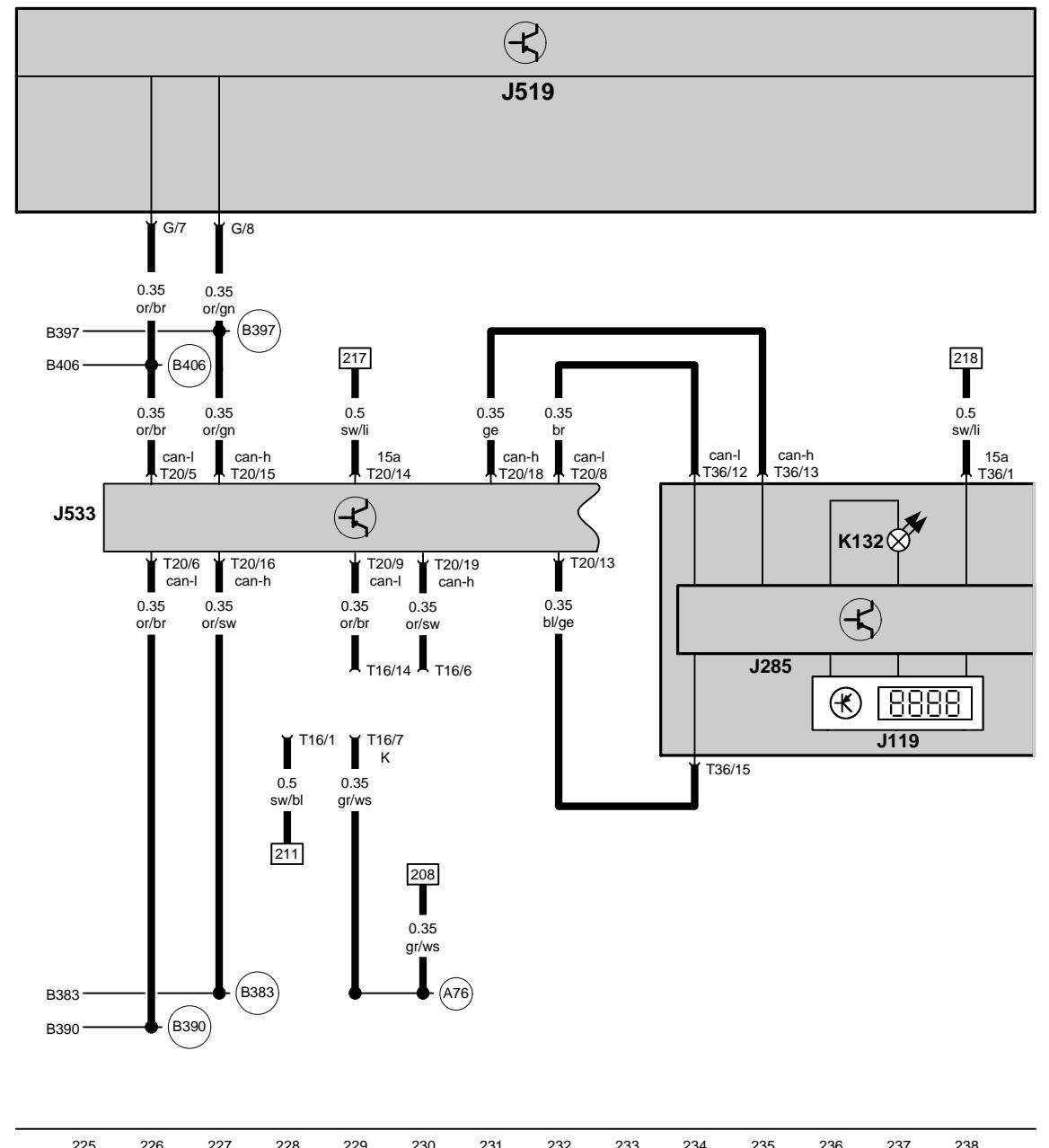
多功能显示、车载电网控制单元、数据总线诊断接口、电子油门操纵机构
