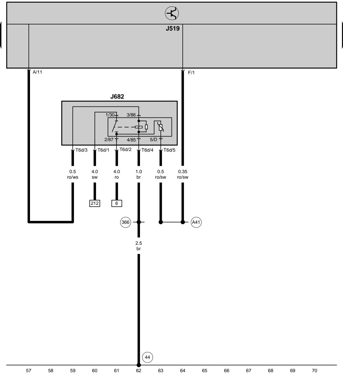
车载电网控制单元、KI.50供电继电器
