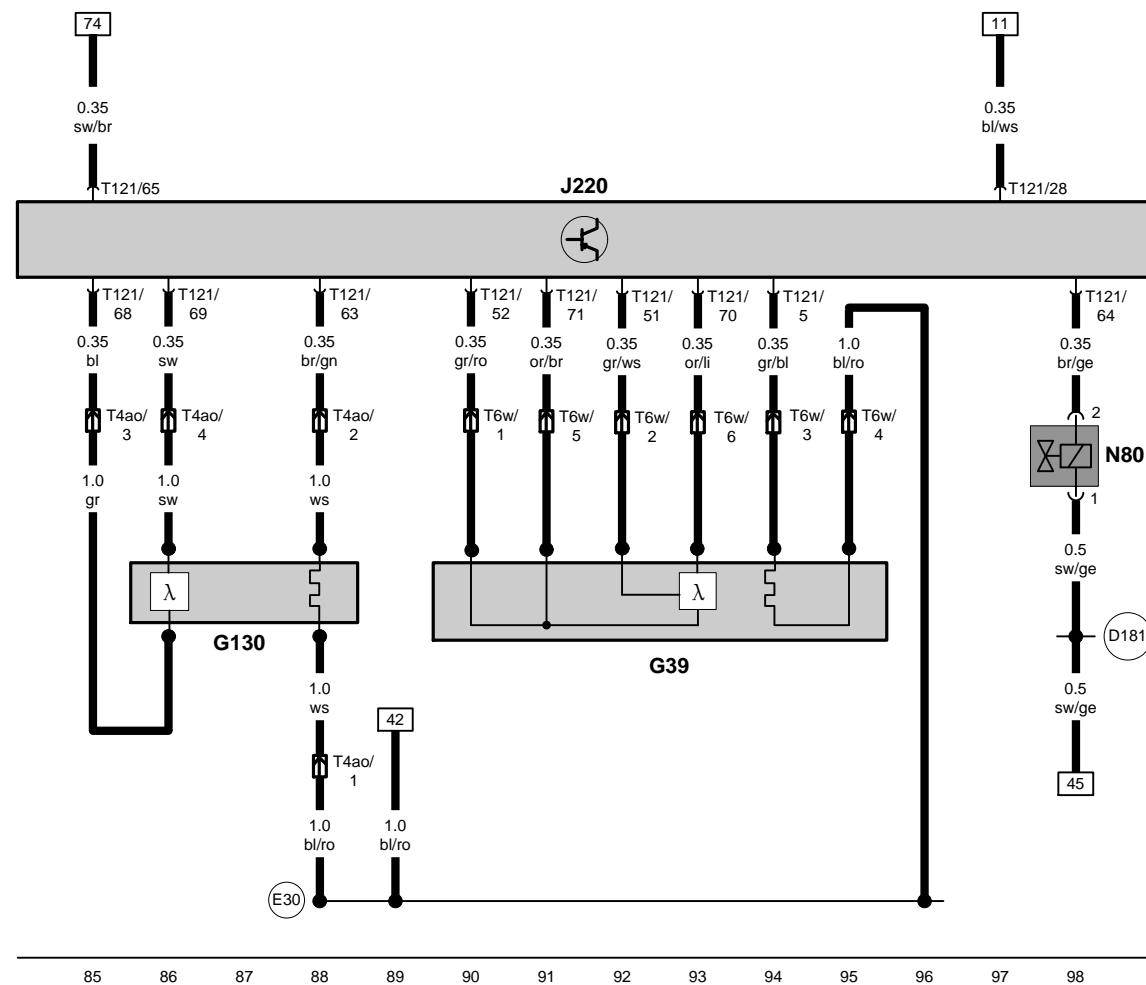
**Motronic**控制单元、催化净化器后的 λ 氧传感器、催化净化器前的 λ 氧传感器、活性碳罐电磁阀1
