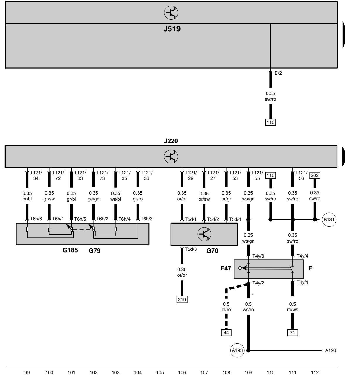
**Motronic**控制单元、油门踏板位置传感器、空气流量计、制动信号灯开关、制动踏板开关
