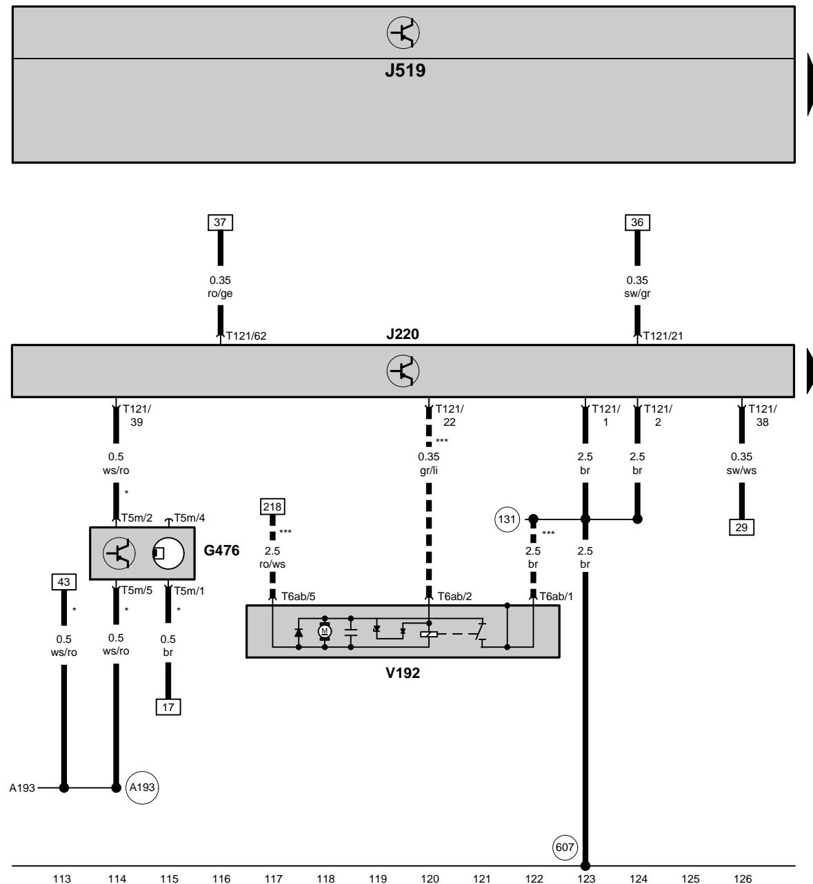
**Motronic**控制单元、离合器位置传感器、制动真空泵
