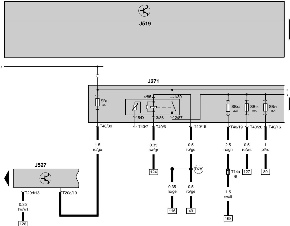
**Motronic供电继电器、转向柱电子装置控制单元**
