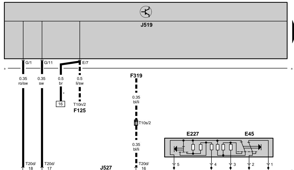
转向柱电子装置控制单元、定速巡航装置开关、点火起动开关、点火钥匙防拔出锁磁铁
